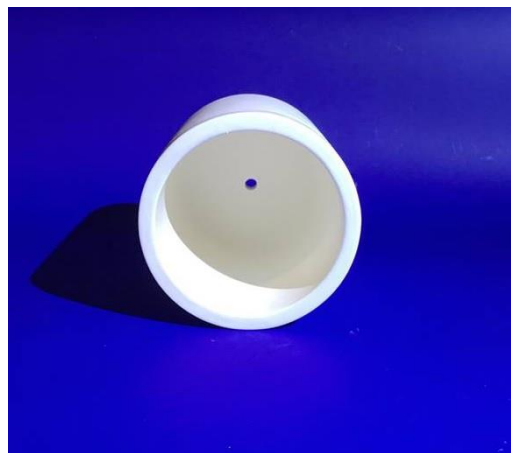
Crisol cilíndrico de 300 ml con perforación en el fondo
